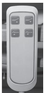
Режим поднятия спинной секции: при нажатии кнопки и удерживании ее в течение более чем 0,5 сек. включается привод для спинной секции, секция начинает подниматься; при отпускании кнопки в процессе подъема спинной секции привод немедленно выключается. При длительном удерживании кнопки в нажатом положении привод для спинной секции автоматически выключается в момент полного поднятия секции.
